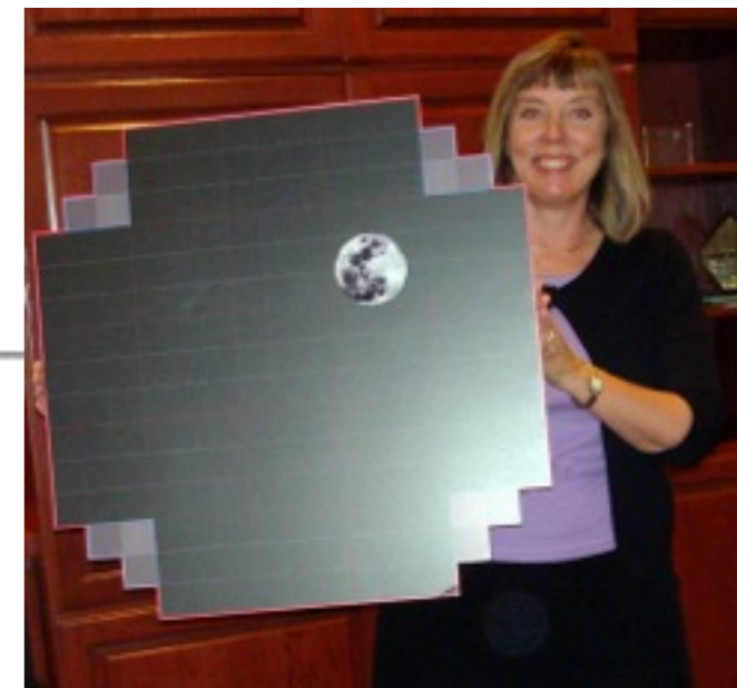
4K x 4K x 189 CCD array
